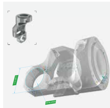
金属製の医療用管体の寸法信頼性および鑄果の有無の解析
