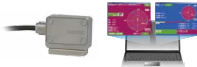
「PULCOM BM-10」は、砥石のアンバランス振動を常時監視し、異常検知をするシステムです。溝研削など複雑な形状の研削盤や小型の精密研削盤で、アンバランス振動がワークに転写され加工精度に影響してしまう問題を解決します。
