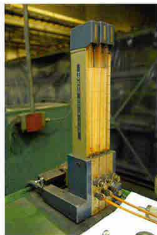
ACCURETECH製の空気マイクロメーター。30年以上前に製造されたものだが、今なお現役。部品の内径を調べるために毎日使用している。
