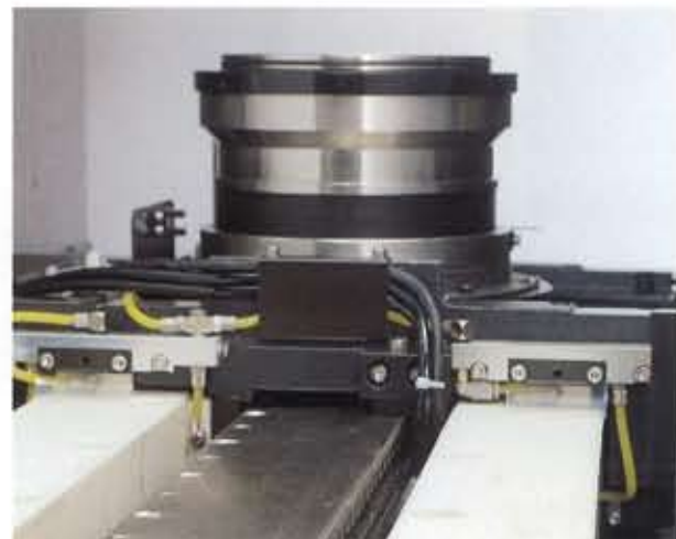
リニアモータとセラミックスガイド、エアベアリングを使用
