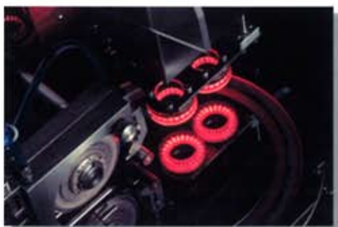
LED照明の採用により、顕微鏡画像の鮮明度及び画像認識精度を向上。(リングライト照明仕様:オプション)
