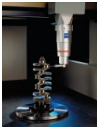
埋込式ロータリーテーブル RT05-400によるクランク測定 (S-ACCのみ)
