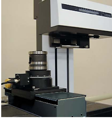
Y軸CNCテーブル(100mm)と θ軸CNCテーブル(水平)の組合せ例
