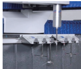
スタイラス交換マガジンを2台取付けた例
