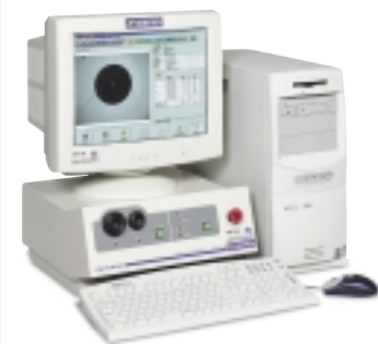
光コネクタ端面自動傷検査装置「CEI-1000A」
